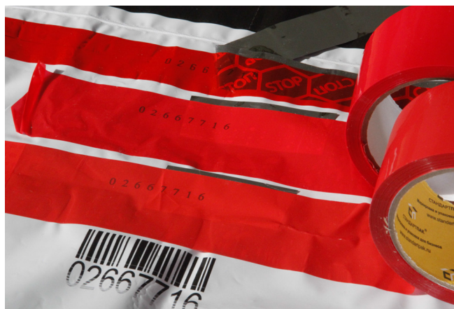
Рис. 8. Упаковочная лента красного цвета может имитировать внешний вид сейф-ленты в запечатанном состоянии. Левая половина каждой ленты полностью приклеена к пакету, в то время как правая половина все еще частично закрыта лайнером. Верхняя лента на фотографии является настоящей сейф-лентой, а две другие ленты — это упаковочный скотч разных марок. Номера на нем были напечатаны на клейкой стороне с помощью ручного капле струйного принтера. Основа всех трех лент прозрачная, окрашен в красный цвет только их клеевой слой
