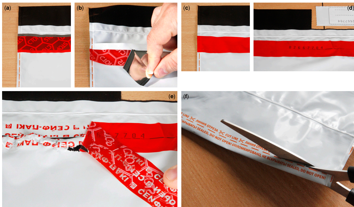
Рис. 7. Штатное использование сейф-пакета. (а) В неиспользованном пакете нижний край сейф-ленты приклеен к пакету. Металлизированный зеркальный лайнер защищает клей на части ее ширины, оставшейся не приклеенной. Часть лайнера выступает над лентой. Лента прозрачна и лайнер можно увидеть сквозь нее. (б) Чтобы запечатать пакет, неприкрепленную часть ленты с лайнером отгибают, не отсоединяя ленту от пакета, так, чтобы ее клеевой слой стал обращен наружу. Лайнер осторожно снимают, не касаясь пальцами клея. Затем ленту разгибают обратно на разрез пакета, прижимают к пакету и она приклеивается к нему намертво. (с) и (d) Сейф-лента с уникальным номером пакета запечатывает разрез. Крупный рисунок сот со словами STOP СТОП является самым внешним слоем ее многослойного клея. Этот рисунок выполнен клеем светло-серого цвета и хорошо просматривается, когда лента не приклеена к пакету или покрыта зеркальным лайнером. Как только клей входит в контакт с пакетом того же цвета, что и клей, рисунок становится почти невидим. (d) Отрывные квитанции можно отсоединить от пакета. (e) Попытка отклеить сейф-ленту растягивает и разрывает материал пакета, разделяет многослойный клей и обнаруживает скрытые в нем надписи. (f) Обычно пакет вскрывают, разрезая его по нижнему краю
